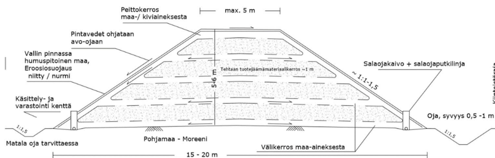
Kuva 1. Suojavallin periaateleikkaus (Ramboll Finland Oy, 20.9.2019).
