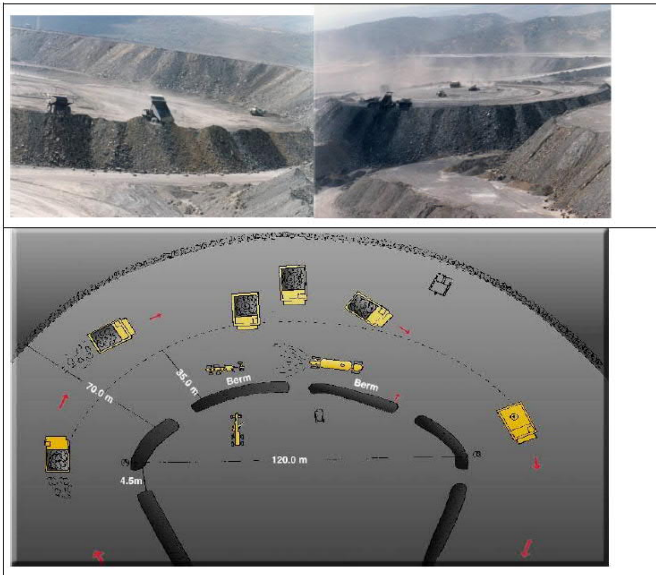
Kuva 3. Tyypillinen sivukivialueen täyttöperiaate
