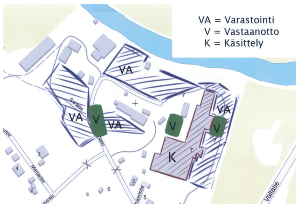
Kuva 1. Toimintojen sijoittuminen uusiomuovin tuotantolaitoksella.
