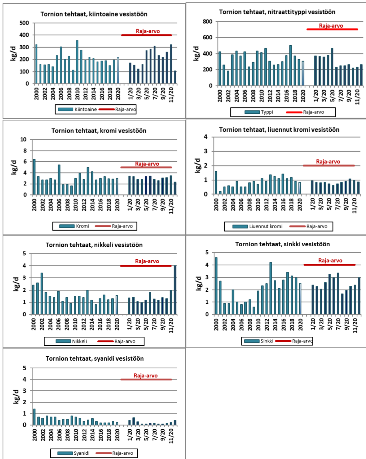
Kuva 3. Tornion tehtaiden jätevesien kiintoaine-, typpi-, kromi-, nikkeli-, sinkki- ja syanidipäästöt vesistöön vuosina 2000 – 2020 (hakemuksen kuva 6).
